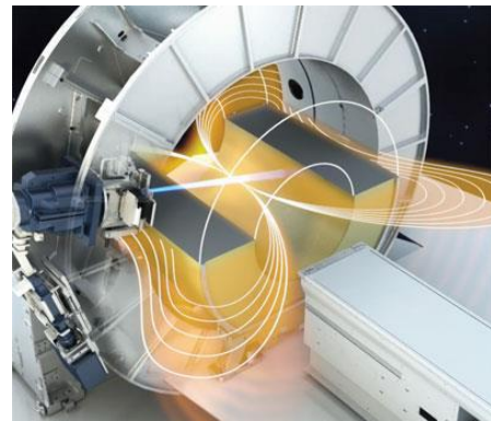
Figure 2. 超電導磁石が発生する磁力線 4)
